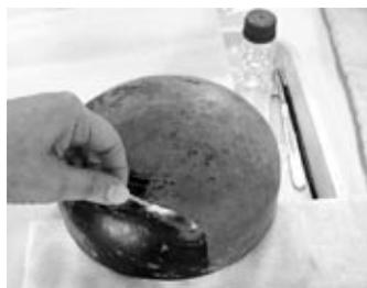
**Foto 7.** Remoción de tinta negra con mezcla de solventes (agua-isopropanol-tolueno).
