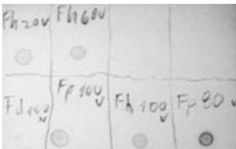
**Figura 8:** Placa cromatográfica del test de solubilidad fotografiada con luz UV onda corta.
