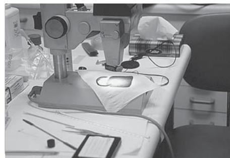
*Foto 5. Microanálisis cualitativos realizados bajo microscopio estereoscópico.*
