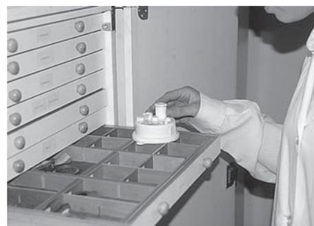
**Foto 1.** Equipo registrador de temperatura y humedad digital.
