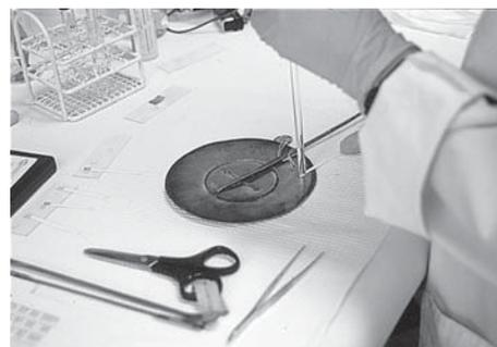
Foto 3. Método de microanálisis cualitativo con varillas analíticas.
