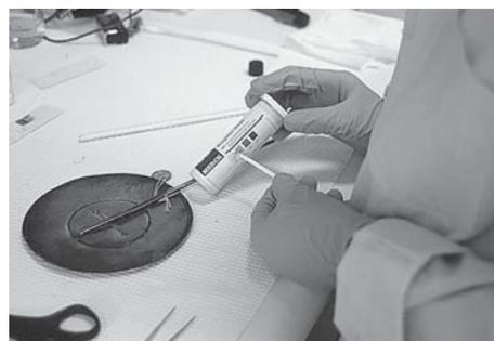
Foto 4. Resultado de análisis del método cualitativo con varillas analíticas.
