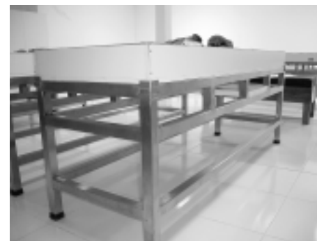
Foto 8. Estante-camilla de acero inoxidable, con doble parrilla, ubicada a un tercio más abajo de la superficie para dar mayor resistencia al movimiento.
