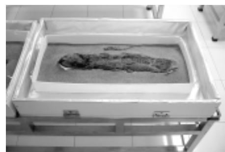
Foto 2. Caja rígida de melamina con bisagras, para abrir lateralmente, con barrera de protección de Marvelseal.
