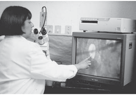
Foto 10. Trabajos de identificación de la madera y del análisis de su deterioro a nivel microscópico. Se observa en el monitor un corte delgado teñido que muestra el daño en pared celular.
