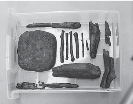
Foto 15. Conjunto de objetos seleccionados para las pruebas de consolidación con sacarosa y polietilenglicol.
