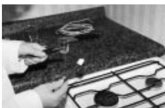
Foto 4. Test de Beilstein.
