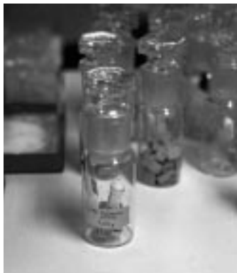
Foto 10. Frasco con muestra y elementos necesarios para el test de Oddy.
