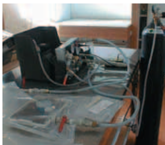
Foto 6. Cámara de desinsectación portátil construida en el CNCR.
